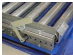
bild 1 exempel på fjäderbelastat manuellt stopp
