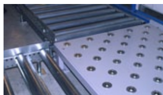
bild 3 exempel på kulbord för riktningsändring
